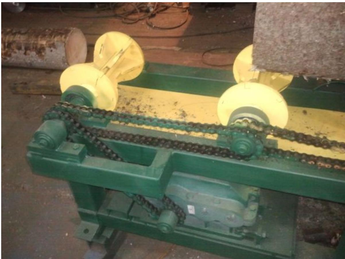
Роликовый транспортер КБС для бревен характеризуется специальной геометрией транспортерных роликов, позволяющих надежно перемещать бревно неправильной геометрии по транспортеру. Компанией производятся транспортеры для бревен (бревнотаски) различных параметров и конструкции.
